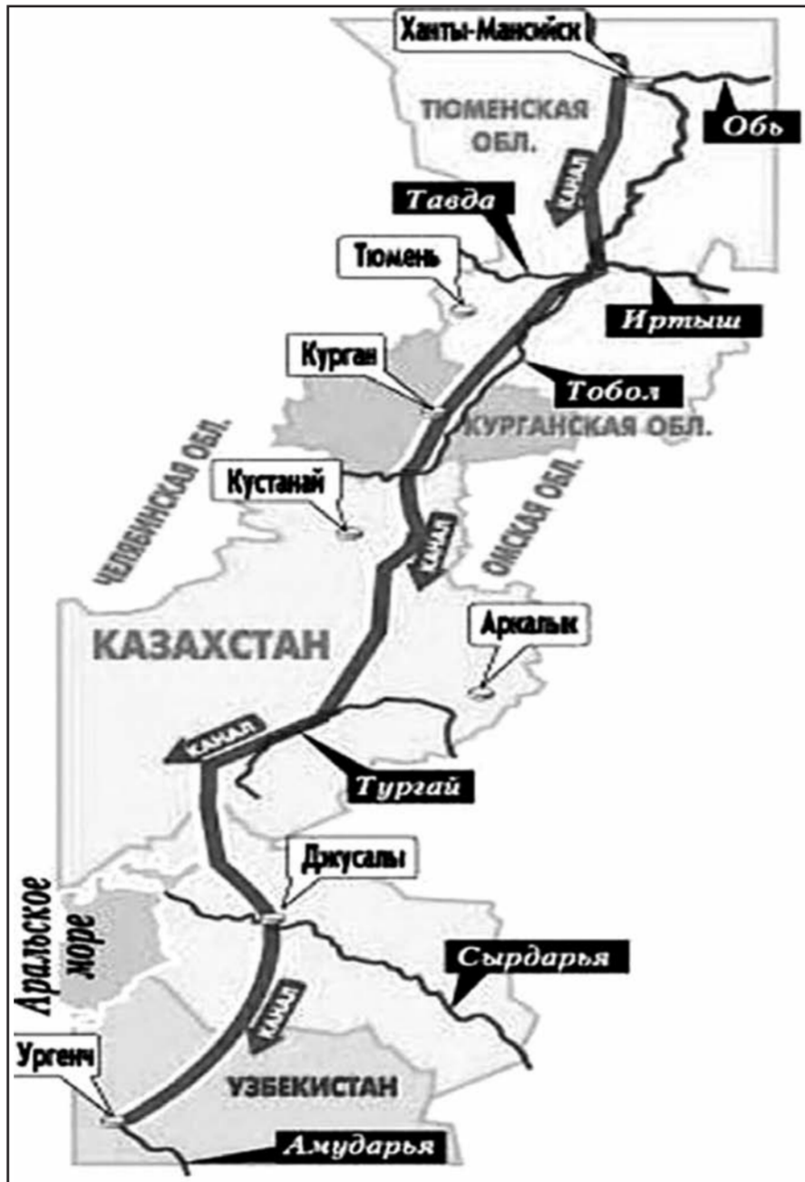
«СИБИРЬ – СРЕДНЯЯ АЗИЯ» Новый проект канала Проект предполагает прокладку канала длиной 2550 км по территории трёх государств (России, Казахстана и Узбекистана). Канал возьмёт начало от слияния Оби и Иртыша в районе Ханты-Мансийска, затем проследует вдоль русла Тобола и по Тургайской ложбине к Аральскому морю. Согласно проекту, ширина канала составит 200 м, глубина – 16 м. Считается, что канал позволит оросить страдающие от недостатка воды сельскохозяйственные земли в России (1,5 млн га), Казахстане и Средней Азии (2 млн га). Ежегодно области будут получать 4,9 км³, Северный Казахстан – 3,4 км³, Сырдарья и Амударья – 16,3 км³
